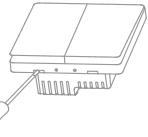
2. 使用螺丝刀拧松开关背面接线柱螺丝，将火线接入L孔，将负载（灯）线接入L1/L2孔（注：L1/L2分别对应开关的左/右按键），确认接线正确后，拧紧接线柱螺丝；
