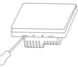
2. 使用螺丝刀拧松开关背面接线柱螺丝，将火线接入L孔，将负载（灯）线接入L1孔，确认接线正确后，拧紧接线柱螺丝；
