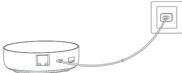
\* Si necesita utilizar una comunicación de red cableada entre Hub y el enrutador, utilice un cable de red con puerto de red RJ45 para conectar el puerto LAN de Hub al puerto LAN de su enrutador, y espere a que se enciendan las luces naranja y verde en el costado del puerto de red.
