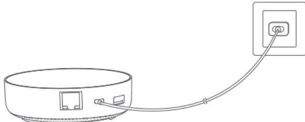
\* Si l'on doit employer la communication réseau limitée entre le Hub et le routeur, veuillez utiliser un câble réseau avec une interface d'accès au réseau RJ45 pour connecter LAN interface du Hub au LAN interface de votre routeur, et puis attendez que les voyants oranges et verts du côté de l'interface du réseau s'allument.
